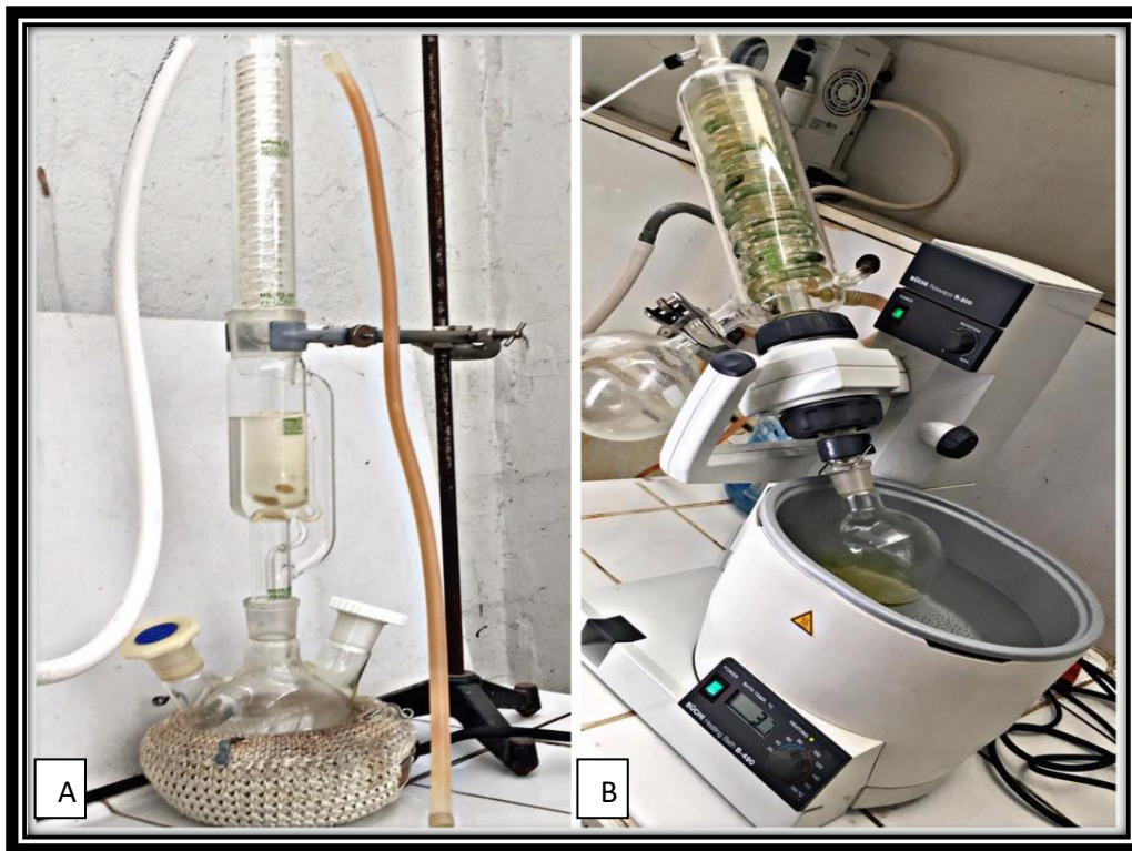
Figure 18 : Etapes d'extraction des métabolites secondaires par Soxhlet (A) et par rotavapor (B).
